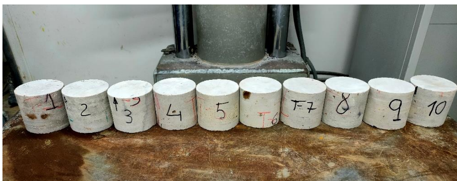
Vista de las probetas de roca tras tallado y rectificado
