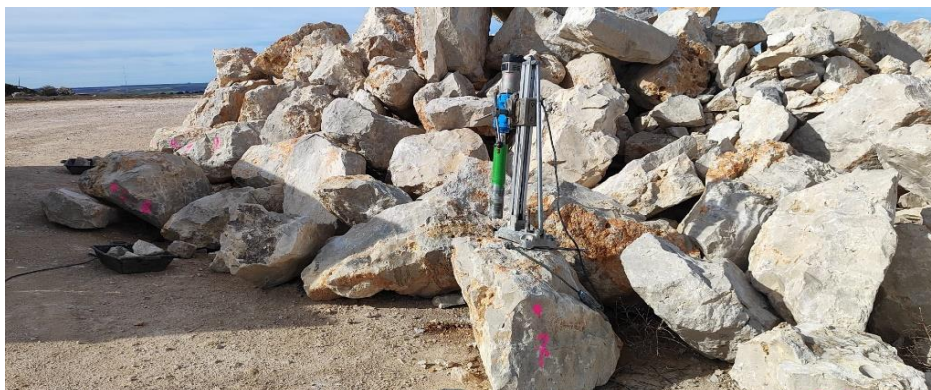
Extracción de testigos de las piedras para escollera
